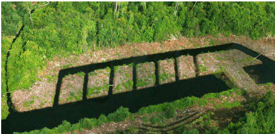
Gambar 12. Sistem Ekohidrologi dengan Desain by Pass Sisir Sebagai Usaha Kendali Air di Lahan Gambut
